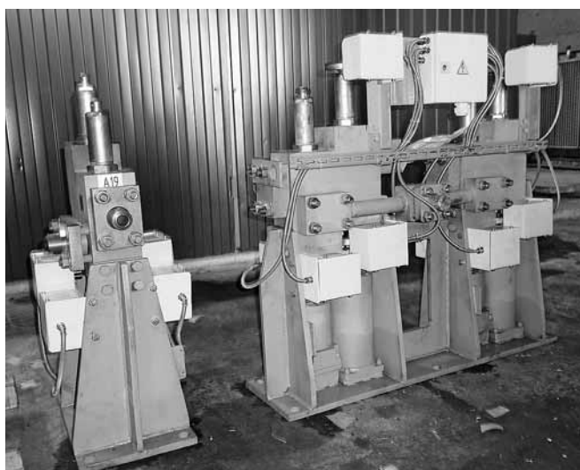
Рис. 7. Клапанные гидрораспределители управления гидроцилиндрами приводов выталкивателя и стола ковочного пресса силой 32 МН на участке отгрузки готовой продукции УриЦ
