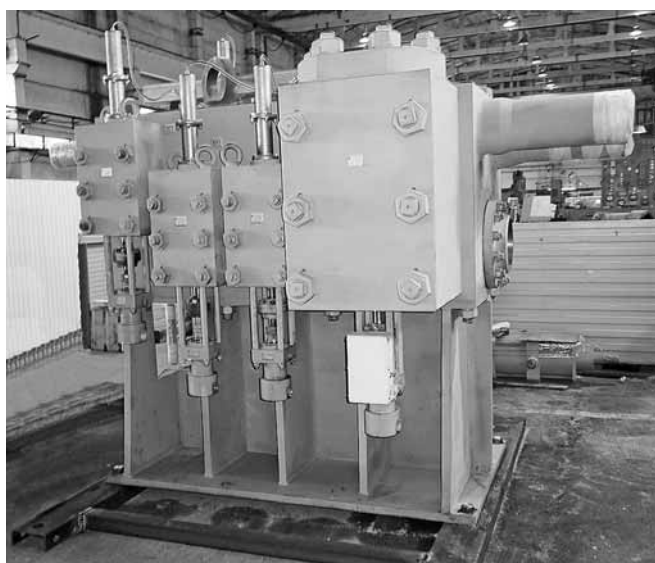
Рис. 2. Гидрораспределитель управления подвижной траверсой ковочного пресса силой 32 МН на участке отгрузки готовой продукции УриЦ
