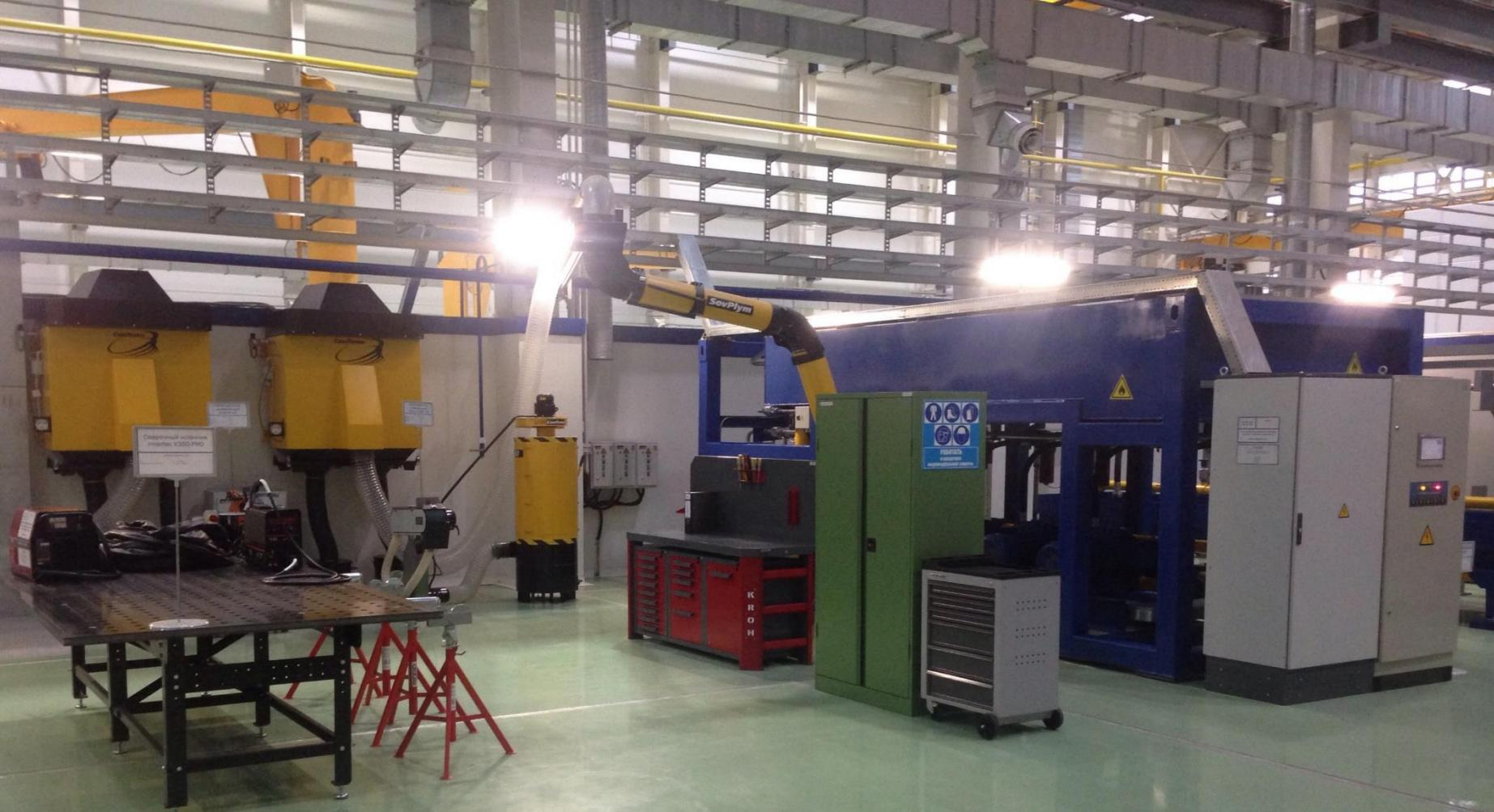
Участок изготовления трубной обвязки системы смазки магистральных насосов
