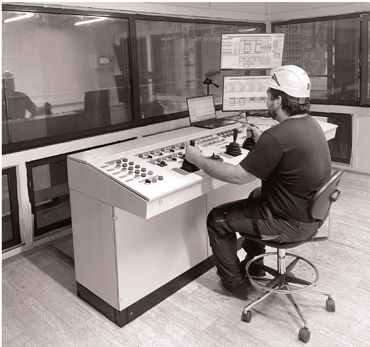
Рис. 8. Общий вид модернизированного пульта управления листоштамповочного пресса двойного действия усилием 150 МН
