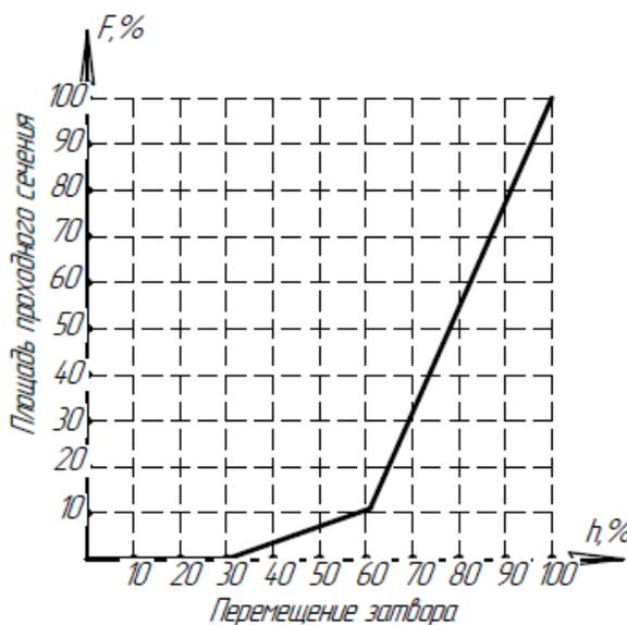
Рис. 1. Характеристика клапана
