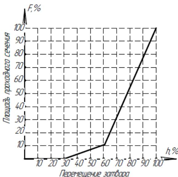
Рис. 1. Характеристика клапана
