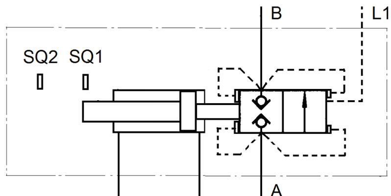
б) направляющего гидрораспределителя
