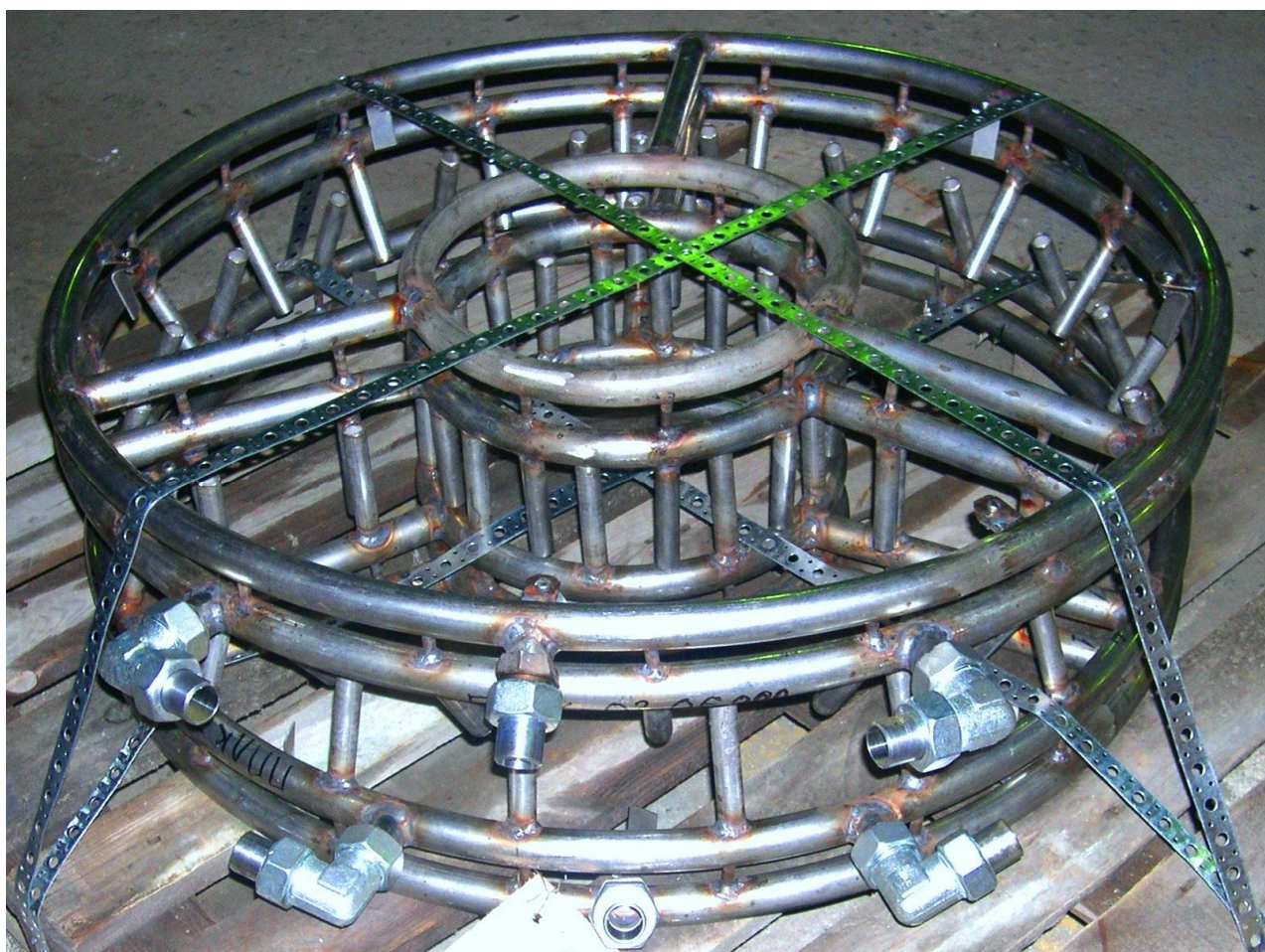
Рис. 2. Кольцевые коллектора к головкам охлаждения и смазки в состоянии отгрузки
