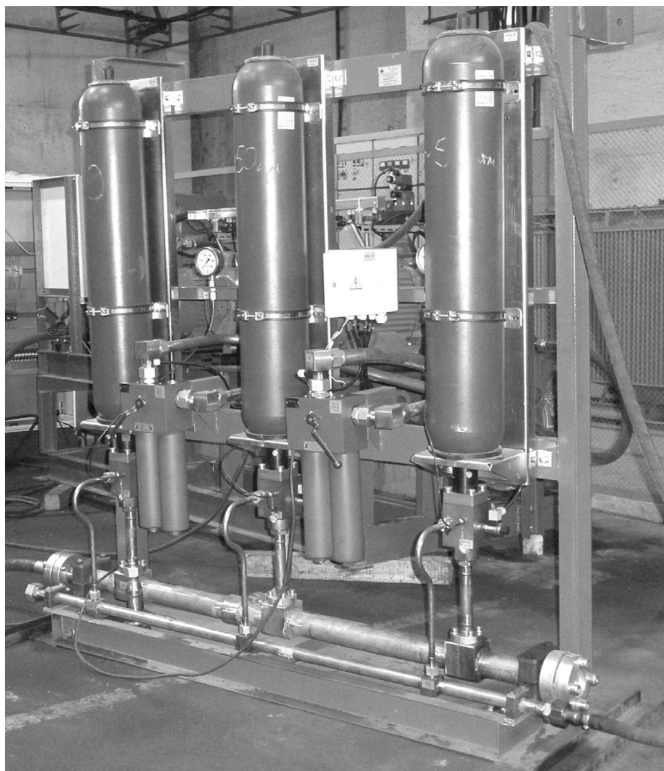
Рис. 5. Блок пневмогидравлических аккумуляторов на участке испытаний готовой продукции ООО “УрИЦ”
