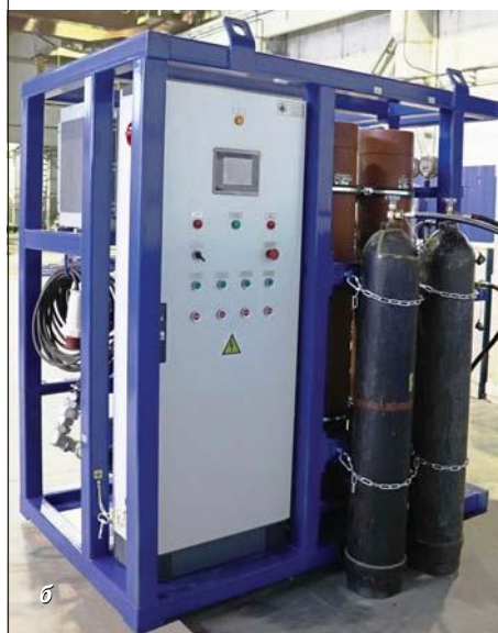
Рис. 3. АЗПГА с рекуперацией энергии на участке испытаний готовой продукции ООО «Уральский инженеринговый центр» (г. Челябинск):
