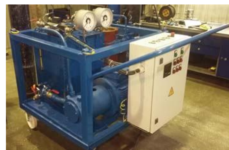
Рис. 1. Общий вид передвижного АЗПГА производства ООО «Уральский инжиниринговый центр» (г. Челябинск).
