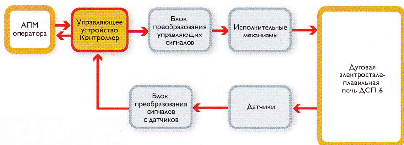
РИС 1. Структурная схема системы управления ДСП-6
