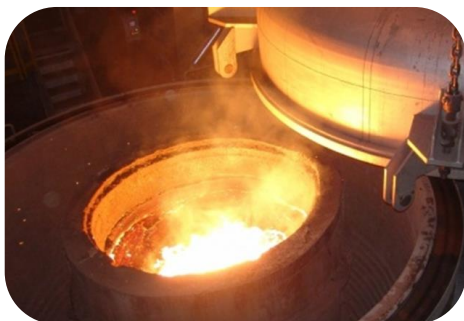
Установки вакуумирования стали
